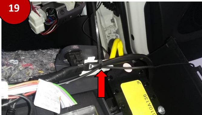
Fissare il cavo del microfono insieme al cablaggio vettura, utilizzando una fascetta.
