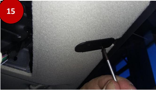
Fissare il supporto del microfono utilizzando le due viti autofilettanti in dotazione. Assicurarsi che sia centrato rispetto al vano plafoniera.
