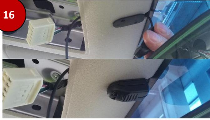
Stendere il cavo tra il parabrezza ed il vano plafoniera, quindi utilizzando il biadesivo preapplicato sul microfono, fissarlo.
