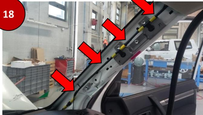
Stendere il cavo in corrispondenza del cablaggio presente in origine e fissarlo in 4 punti con del nastro adesivo.
