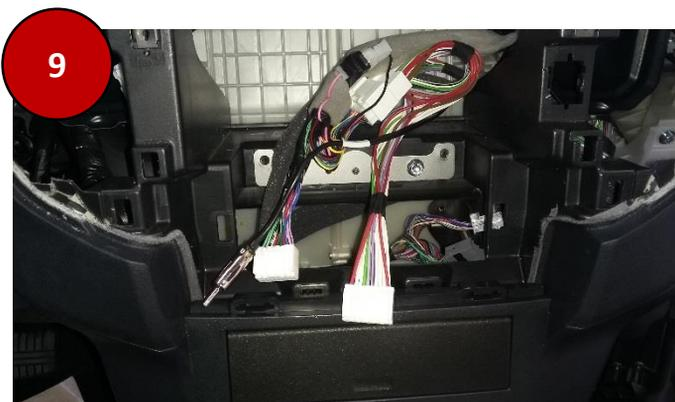
Stendere il cablaggio vivavoce, tra vano radio e vano cassetto portaoggetti. Connettere quindi il connettore radio con quello del cablaggio vivavoce.
