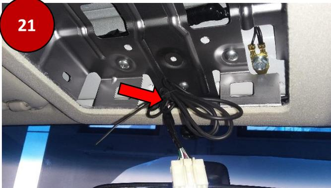
Fissare il cavo del microfono con una fascetta nel vano plafoniera.
